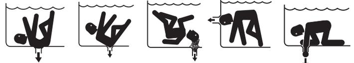
ESTA BOMBA PRODUCE ALTOS NIVELES DE SUCCIÓN Y CREA UN FUERTE VACÍO EN EL DRENAJE PRINCIPAL, EN LA PARTE INFERIOR DE LA MASA DE AGUA. LA SUCCIÓN ES TAN FUERTE QUE PUEDE ATRAPAR A ADULTOS O NIÑOS BAJO EL AGUA SI SE ENCUENTRA PRÓXIMOS A UN DRENAJE O A UNA CUBIERTA O REJILLA ROTA O SUELTA DEL DRENAJE.
